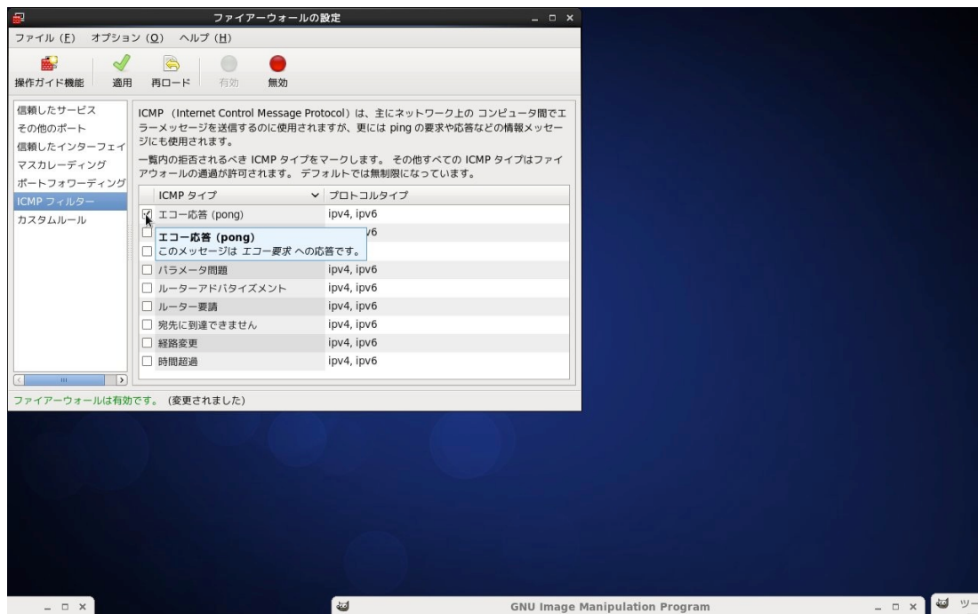
図 3.13 system-config-firewall の ICMP フィルター表示
