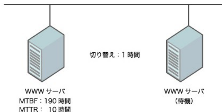
図 1-2: アクティブ・スタンバイシステムの構成例
